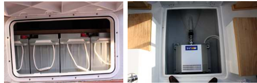
Baterías y motor de un Aquabus 1050T
